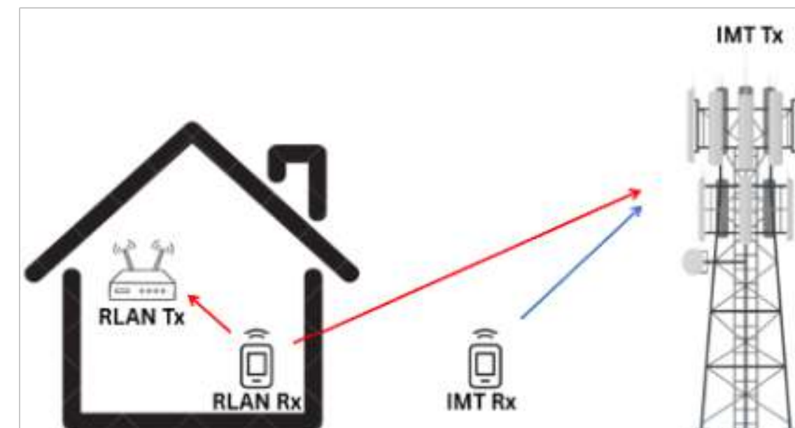
Skenario 3: RLAN (Wi-Fi 6/7) dan IMT sama-sama dalam kondisi uplink , diukur pada base station (BS) IMT
